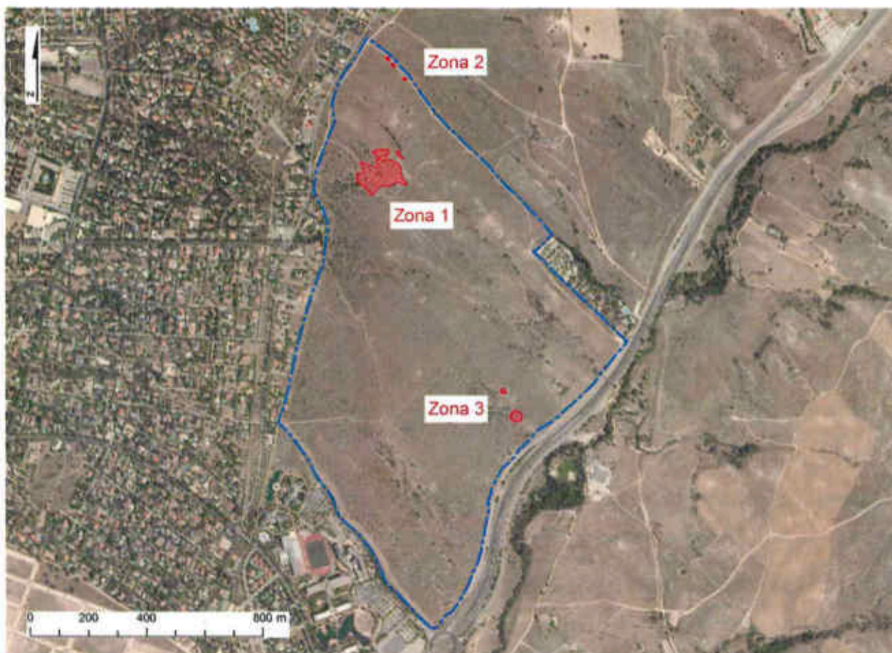
Figura 27. Zonas con escombros de RCD identificadas en el interior del ámbito
