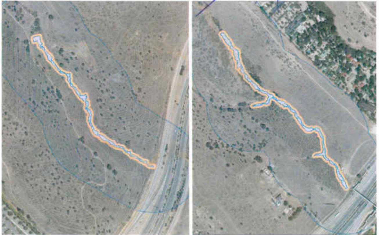
Figura 22. Detalle de la Máxima Crecida Ordinaria para los cauces Oeste (izquierda) y Este (derecha). Situación preoperacional
