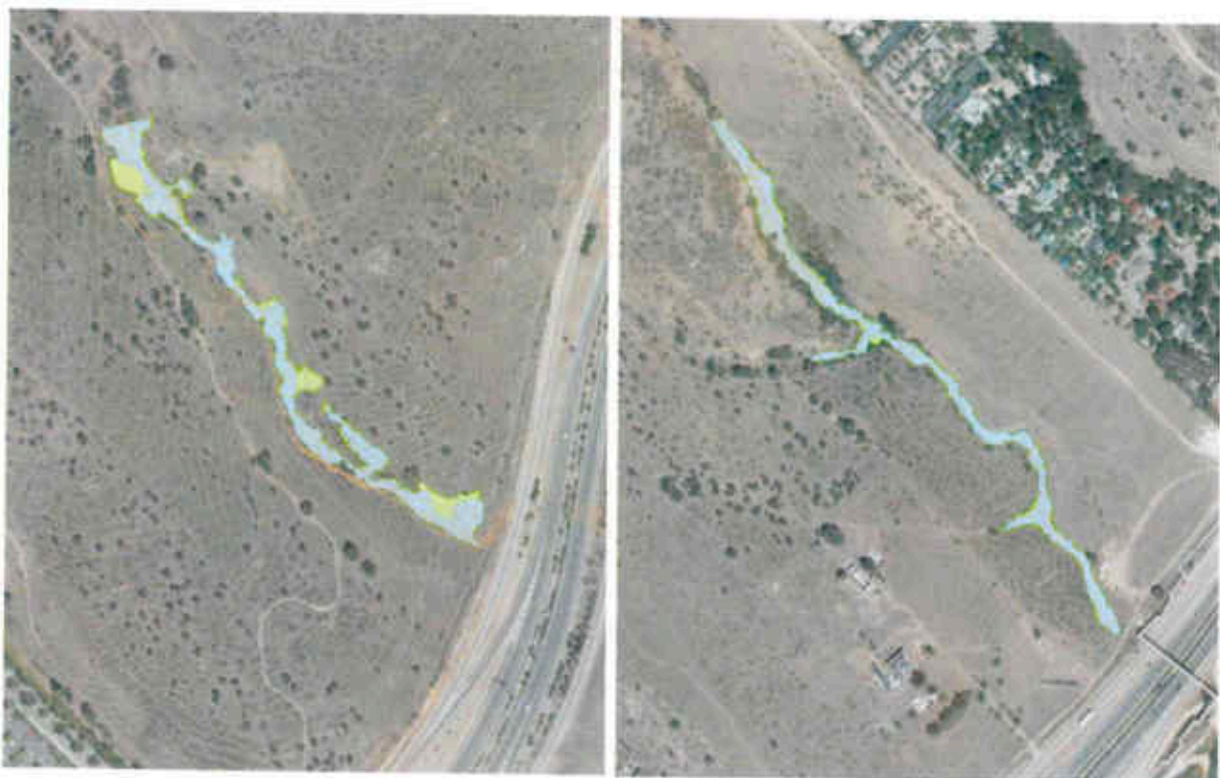
Figura 29. Avenidas de T100 (azul) y T500 (verde) en los cauces Oeste (izquierda) y Este (derecha). Situación postoperacional
