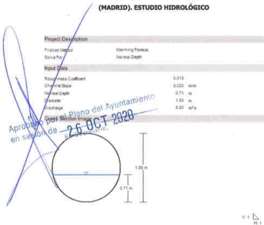
Figura 31. Altura de la lámina de agua esperada en la obra transversal situada al Este del ámbito. Situación postoperacional T500
