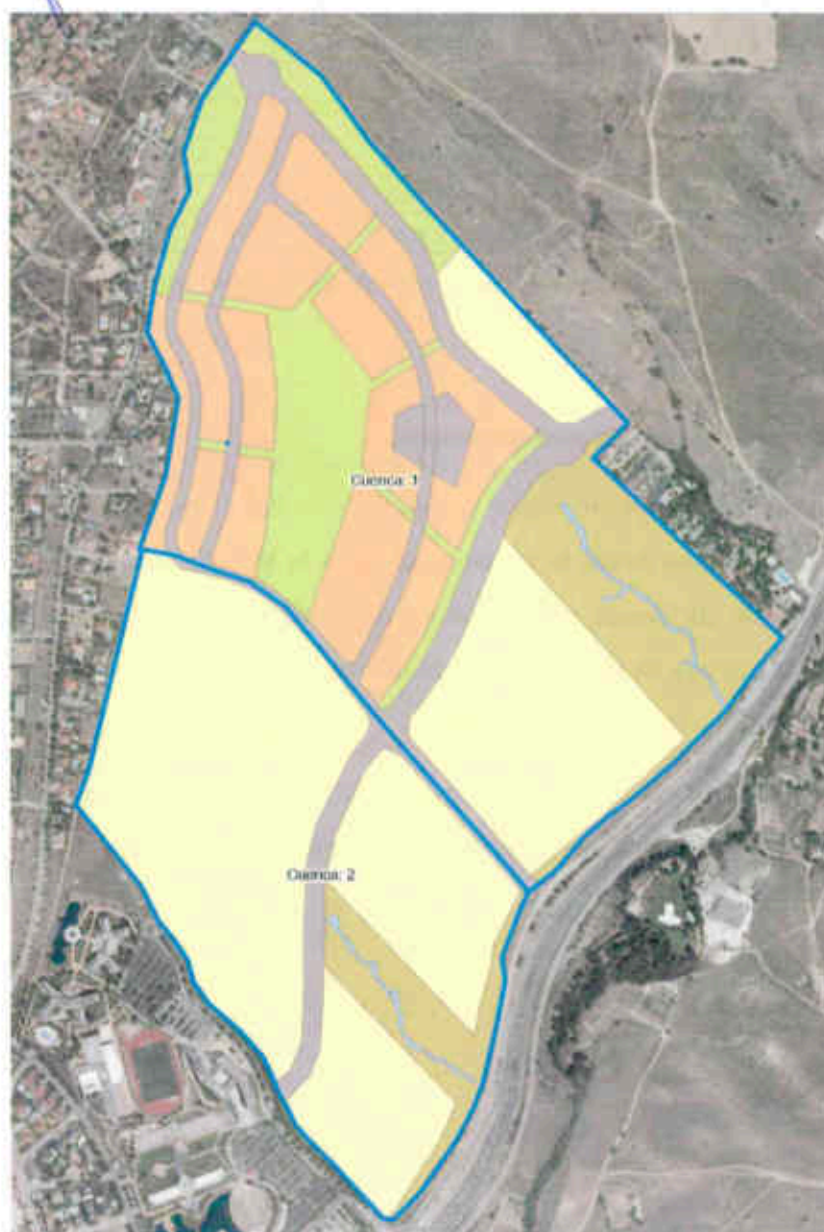
Figura 21. Cuencas de drenaje. Situación postoperacional
