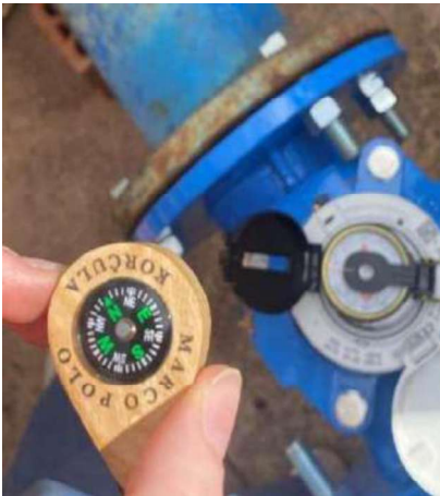
Ilustración 8. Distorsión magnética en los contadores. Fuente: Informe del Servicio Técnico Municipal del Ilmo. Ayuntamiento de Villaviciosa de Odón.
