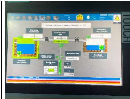
Fig.26.- Sinóptico del Pozo Nº11 (SCADA)
