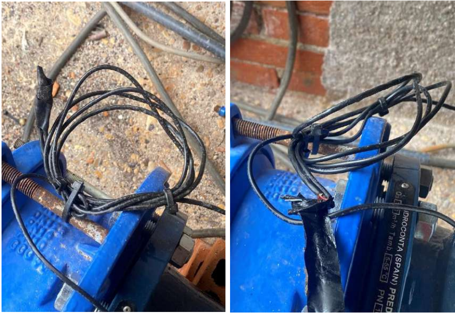
Fotografía 9 y 10. – Detalle de la sonda con presencia de cinta aislante que al retirarse muestra los cables cortados y empalmados. Indicio de manipulación en Pozo N°11.
