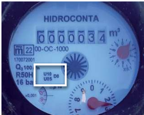
Contador UOS cuando hay tramo anterior con estabilizador de flujo
