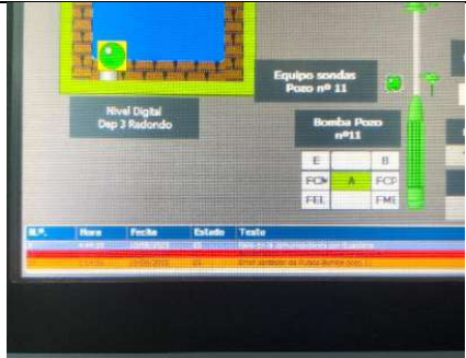
Fig.25.- Detalle de alarmas del Sinóptico del Pozo Nº11 (SCADA)
