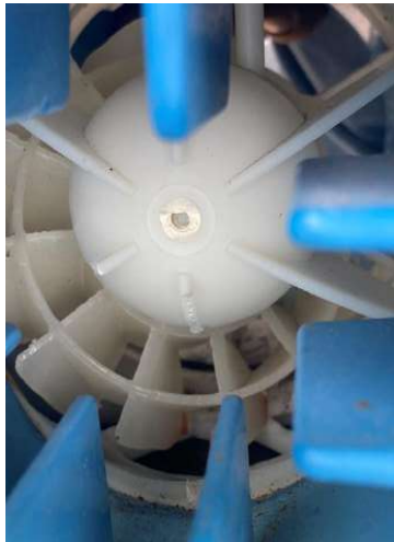
Fotografías 18 y 19 – Detalles del Contador CHT (Desmontado) del Pozo Nº1 – Hélice rota.
