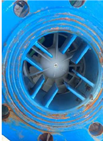
Fotografías 18 y 19 – Detalles del Contador CHT (Desmontado) del Pozo Nº1 – Hélice rota.
